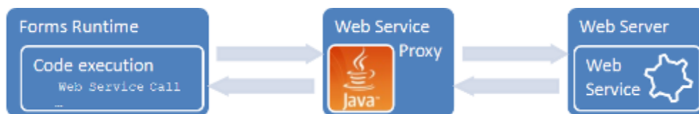
Abbildung 2: Die Kommunikation zwischen Forms und Web Service über Proxy
